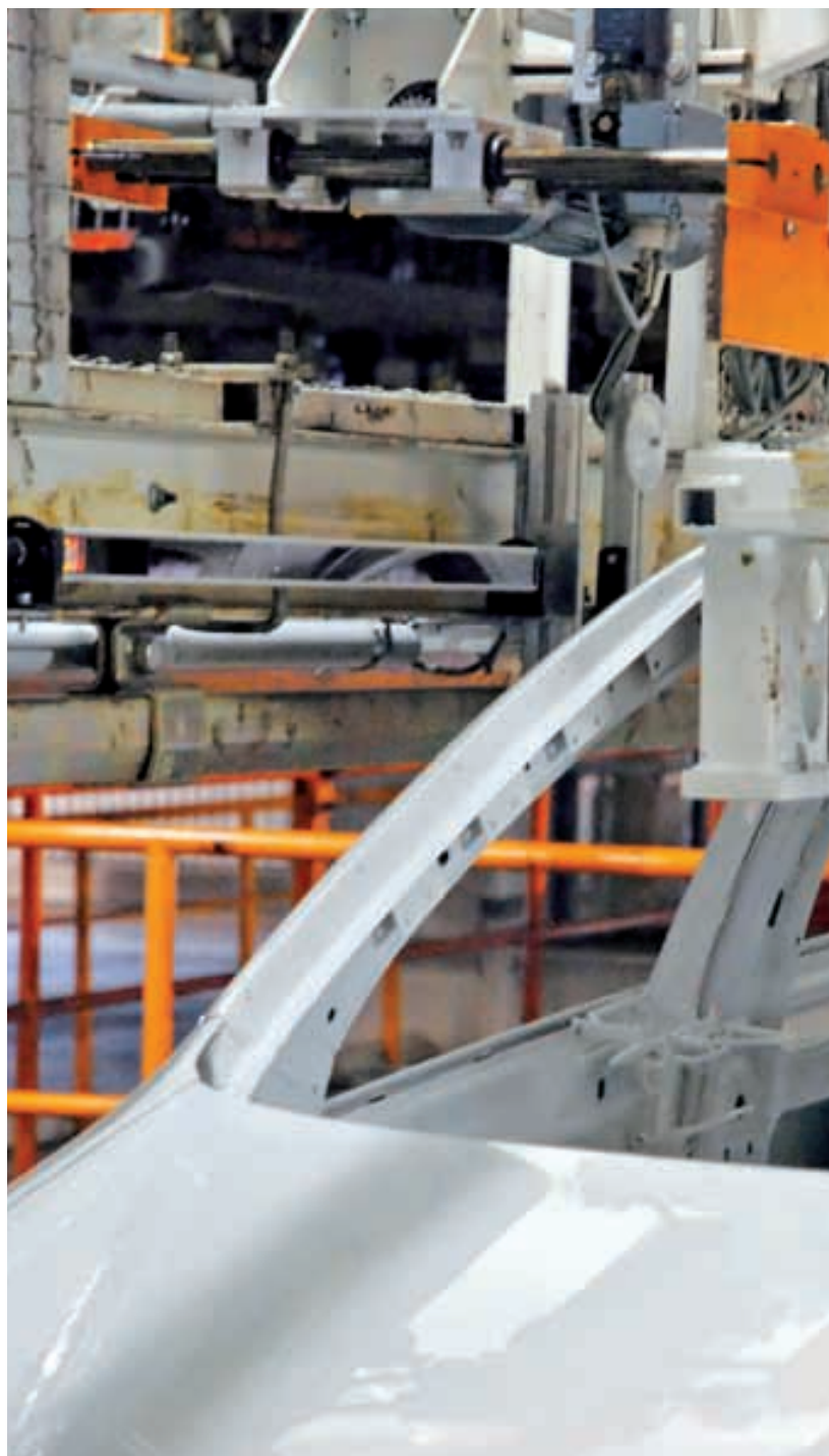
Die messenden Lichtvorhänge EZ-Array erfassen die Positionen von Karosse und Greifarmen in Echtzeit und kompensieren so alle Toleranzen
