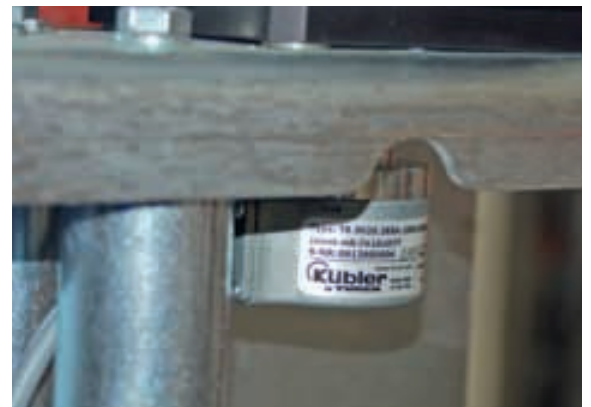
Für einen Pro-Pack-Kunden hat Turck einen speziellen Drehgeber mit d-sub-Steckverbinder gebaut
