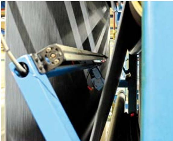
**EZ-Array-Lichtvorhänge prüfen die Teppichbreite in der Produktion mit 10-fach höherer Genauigkeit**
