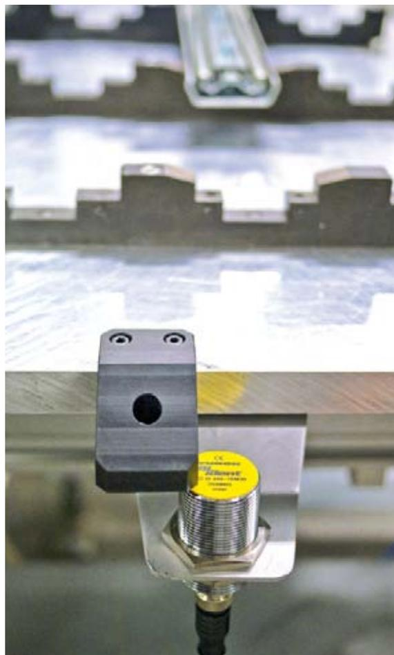
Mit der schwarzen Kunststoffhalterung wurde der Tag am Werkstückträger montiert
