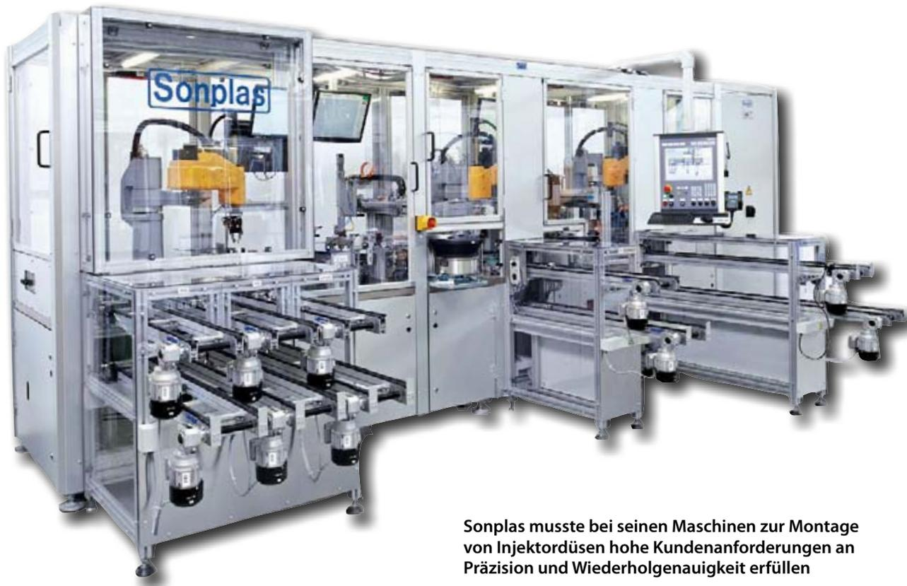
**Sonplas musste bei seinen Maschinen zur Montage von Injektordüsen hohe Kundenanforderungen an Präzision und Wiederholgenauigkeit erfüllen**
