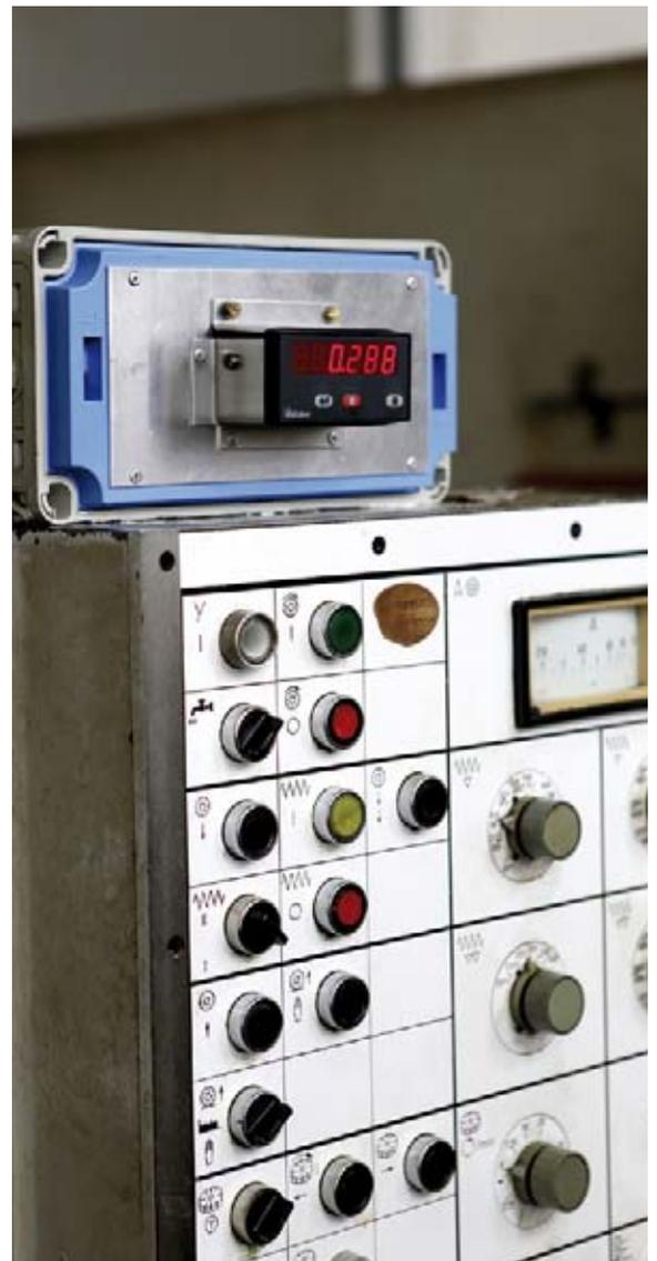
**Auf dem Bedienpult der Flachsleifmaschine zeigt die Digitalanzeige den Messwert des LI-Sensors an**
