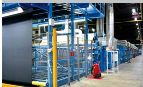
Vebe Floorcoverings in den Niederlanden vermisst die Breite von Teppichbahnen bei 35 m/min mit EZ-Array-Lichtvorhängen 10-fach genauer als zuvor. **Seite 26**
