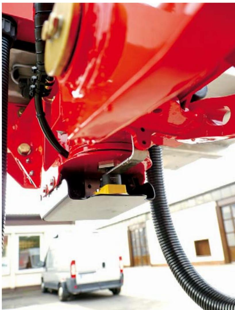
Der kompakte Ri360-QR14 ist durch die Stahlhaube zuverlässig vor mechanischen Schäden geschützt
