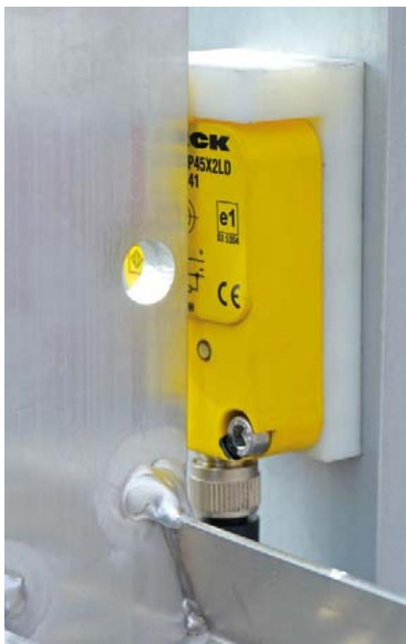
**Der Bi20-Q20 erfasst an der Korb-Außenwand die hochgeklappte Leiter**
