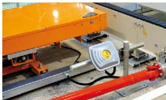
Turcks UHF-RFID-System BL ident erfasst bei einem chinesischen Automobilhersteller die Datenträger an den einzelnen Karosserieteilen. **Seite 18**
