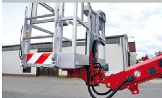
Ruthmann hat STEIGER®-Hubarbeitsbühnen mit Turcks induktivem Winkelsensor Ri360 zur Erfassung des Personenkorbs-Schwenkwinkels ausgestattet. **Seite 28**
