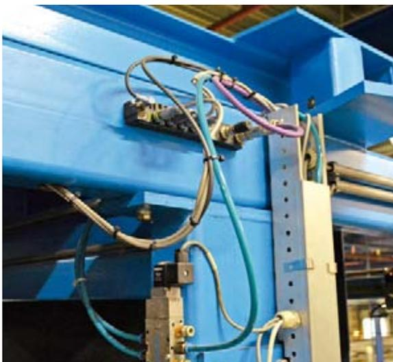
**Turcks Block-I/O-Modul bringt über IO-Link und Profibus die digitalen Messsignale an die Steuerung**
