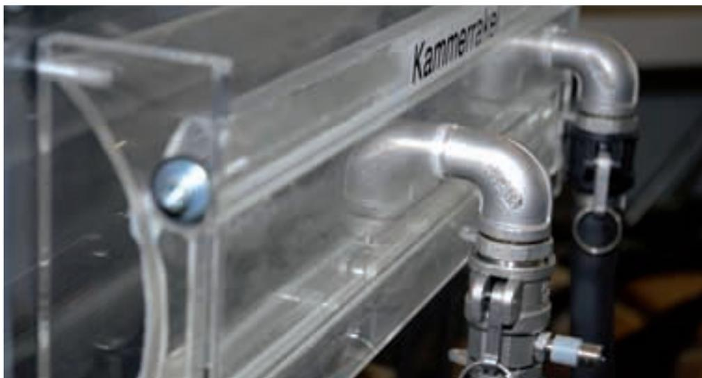
**Innovation: Die Lacktemperatur wird mittels PT100 direkt an der Kammerake (hier ein Messemodell) erfasst**
