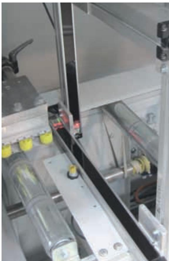
Die EZ-Array verfügen über integrierte Controller
