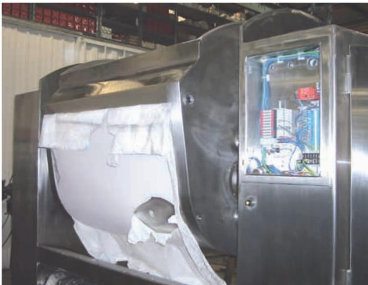
**Montagefreundlich: Das modulare I/O-System BL20 halbiert die Installationszeit der neuen Peerless-Maschinen; lange Kabalkanäle sind jetzt ebenso überflüssig wie fest verdrahtete Peripherie**
