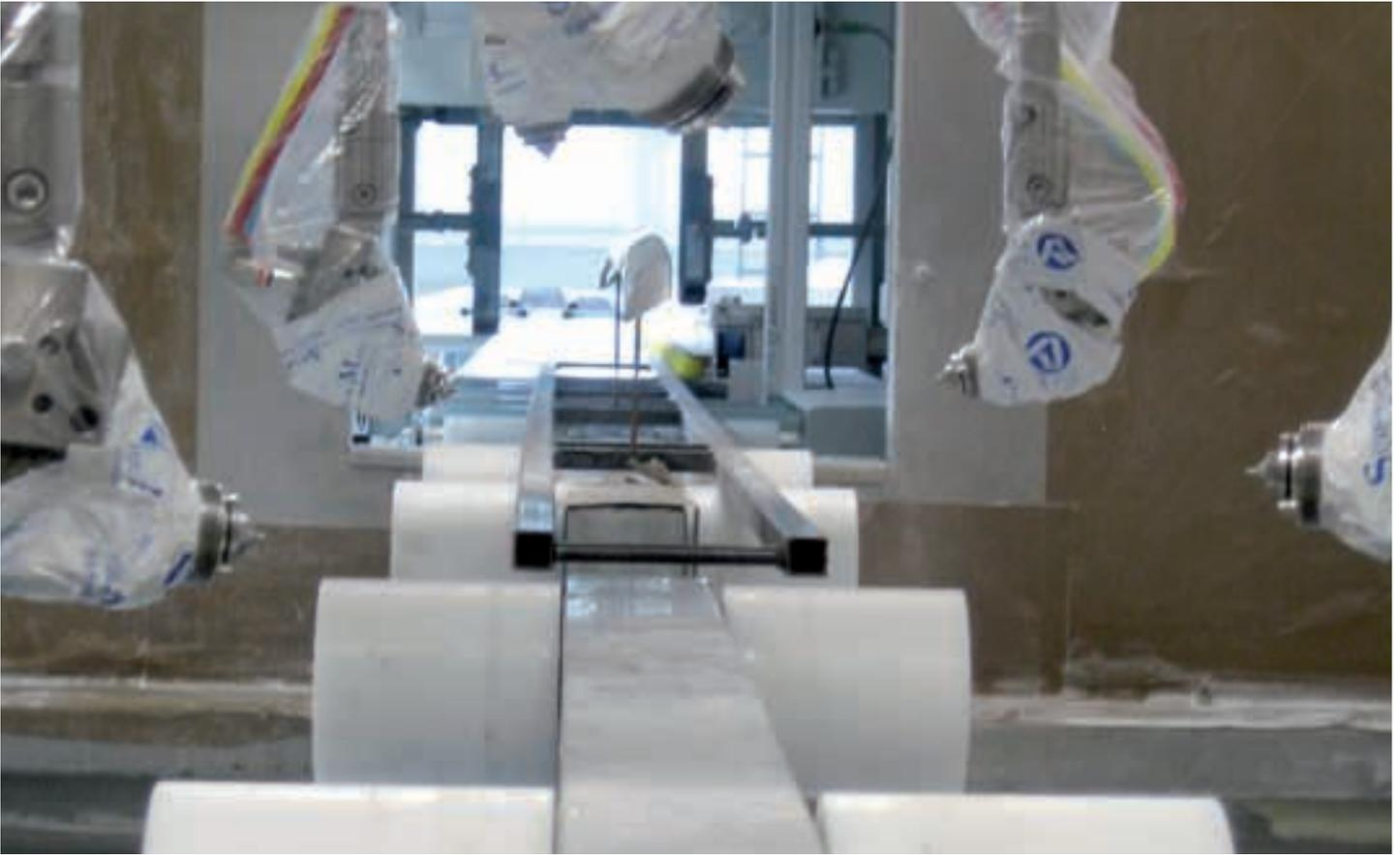
Die Stege des Werkstückträgers werden von der Steuerung direkt ausgeblendet, sodass die Kontur der Zierleiste korrekt erfasst wird
