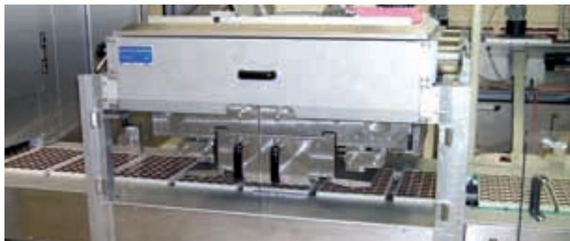
**Beispiel Produktion: In den Süßwarenmaschinen von Winkler und Dünnebier garantiert RFID jederzeit den Überblick über alle eingesetzten Formen**
