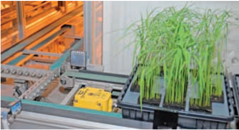
Nach dem Durchfahren der Spritzkabinen werden alle relevanten Daten auf den RFID-Tag in der Schalenmitte geschrieben
