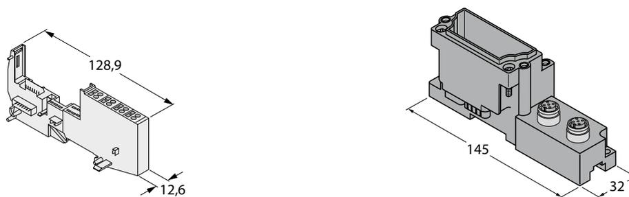
Abb. 9: Basismodule für BL20 (links) und BL67 (rechts)
