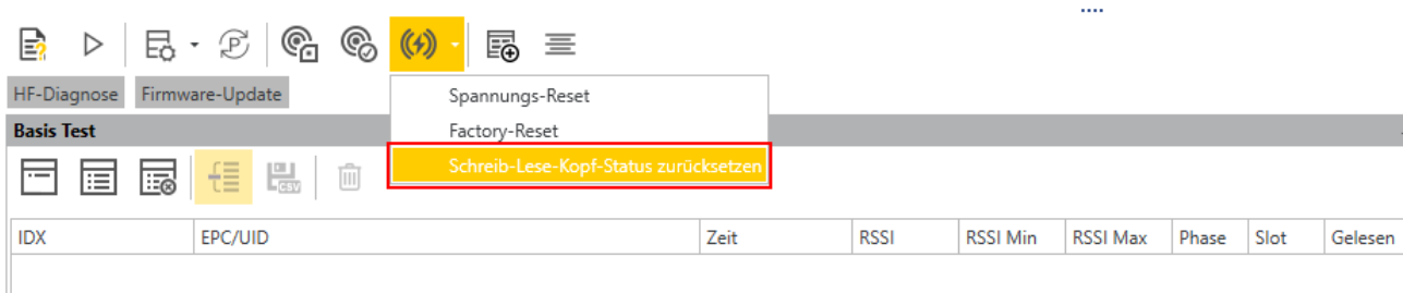
Abb. 42: DTM – Schreib-Lese-Kopf-Status zurücksetzen
