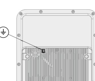
**DE** Kurzbetriebsanleitung**Erdung****WARNUNG****Gefahr eines elektrischen Schlages!**
