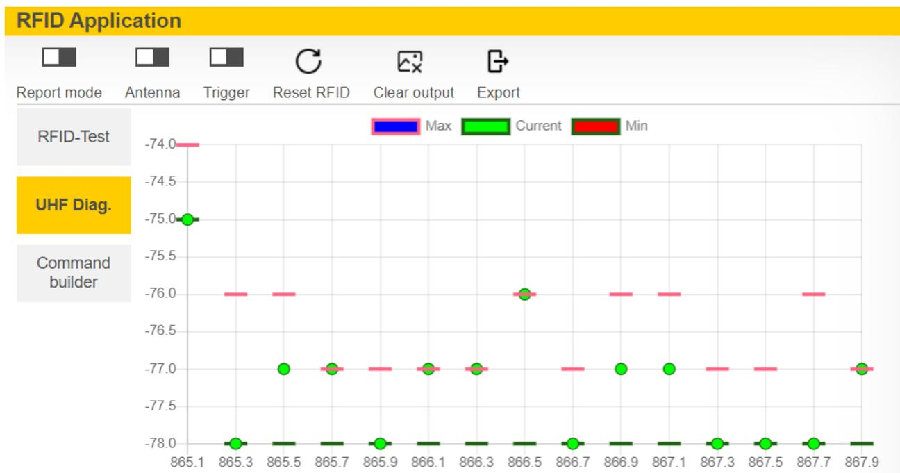
Abb. 21: Beispiel UHF-Diagnose: Empfangener Leistungspegel pro Kanal
