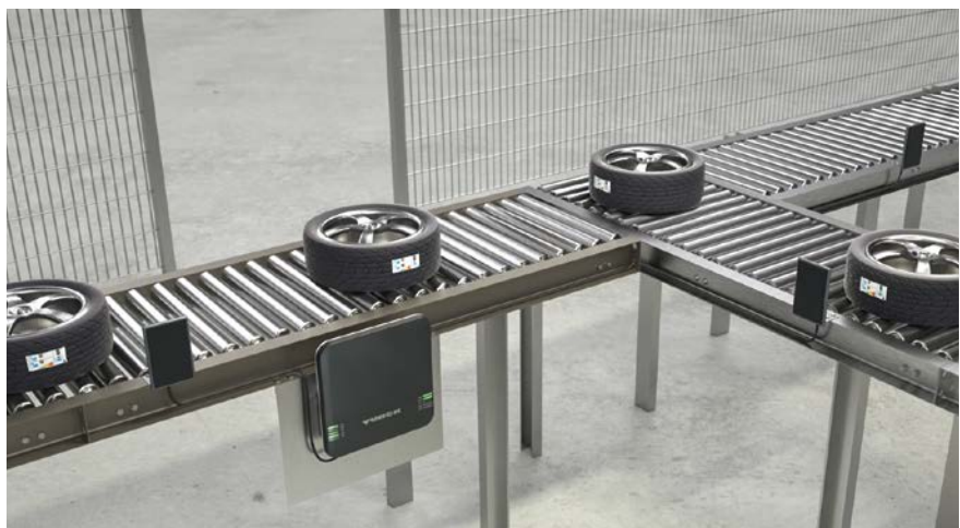
Erfassung einzelner Produktionsgüter auf einem Förderband
