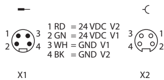
Abb. 24: Pinbelegung Versorgungsspannungsanschlüsse, 7/8", 4-polig
