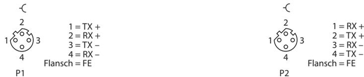
Abb. 18: Pinbelegung Ethernet-Anschlüsse
