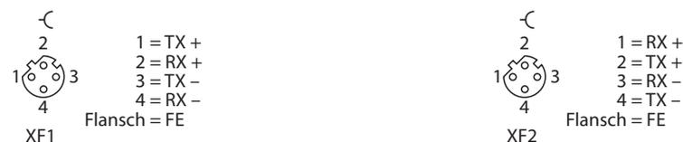
Abb. 20: Pinbelegung Ethernet-Anschlüsse
