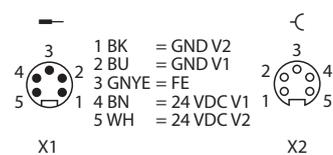
Abb. 24: TBIP-L5... – Pinbelegung Versorgungsspannungsanschlüsse
