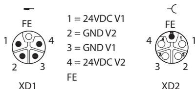
Abb. 26: Pinbelegung Versorgungsspannungsanschlüsse
