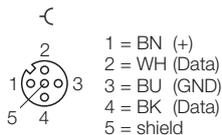
Abb. 17: Verbindungsleitungen .../S2501 – Pinbelegung Anschlüsse für Schreib-Lese-Gerät
