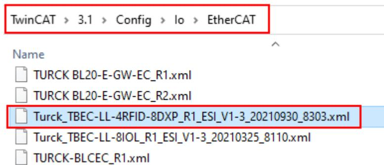
Abb. 24: TwinCAT – xml-Datei im Installationsverzeichnis ablegen
