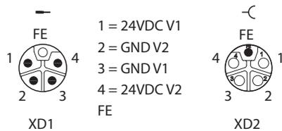
Abb. 10: Pinbelegung Versorgungsspannungsanschlüsse
