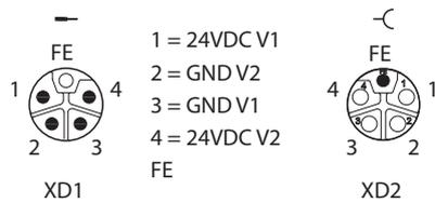
Abb. 23: Pinbelegung Versorgungsspannungsanschlüsse
