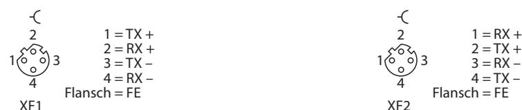
Abb. 19: Pinbelegung Ethernet-Anschlüsse
