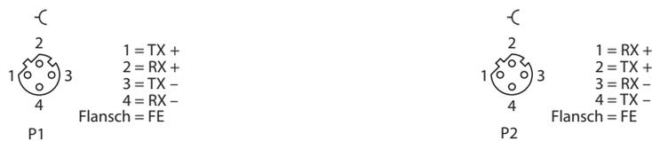
Abb. 17: Pinbelegung Ethernet-Anschlüsse
