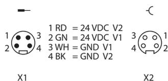
Abb. 21: TBEN-L4... – Pinbelegung Versorgungsspannungsanschlüsse
