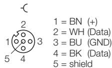
Abb. 20: Verbindungsleitungen .../S2501 – Pinbelegung Anschlüsse für Schreib-Lese-Gerät
