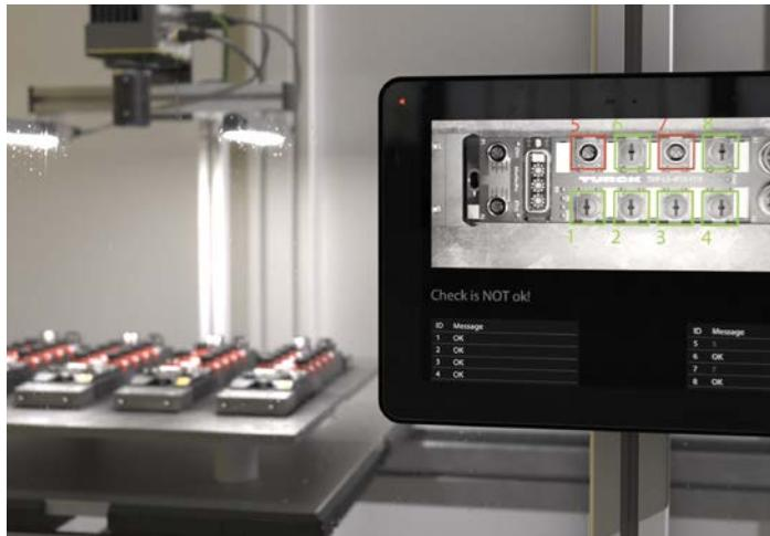
AI-Kamera garantiert fehlerfreie Bestückung
