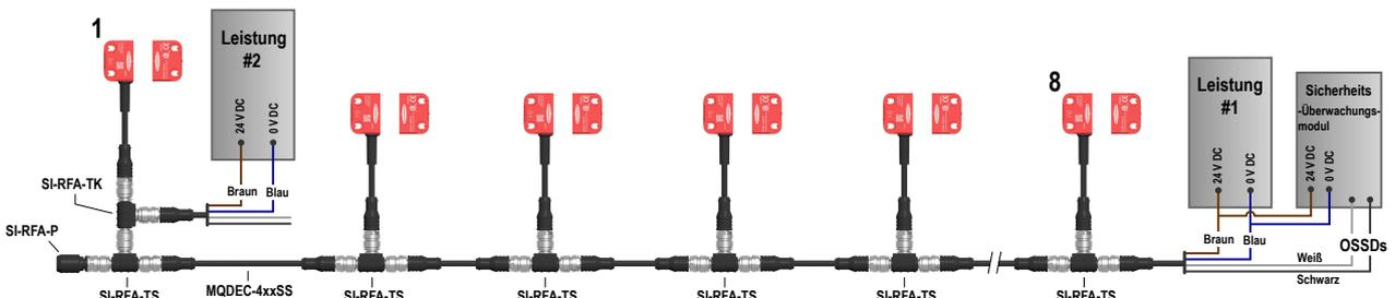
Abbildung 9. Möglichkeit 2: Ersetzen Sie den Abschlusswiderstand durch eine Stromversorgung. Die OSSD1- und OSSD2-Leiter an der Stromversorgung Nr. 2 müssen an +24 V DC angeschlossen werden. Falls verfügbar, stellen Sie die Stromversorgungen für parallel geschaltete Ausgänge ein.
