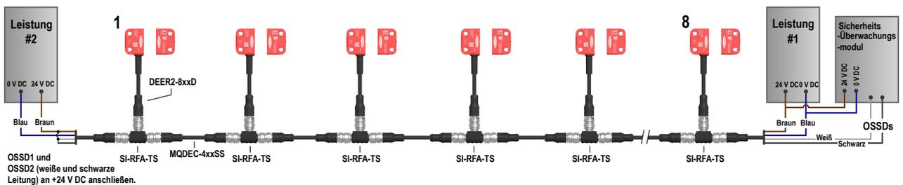
Abbildung 10. Maximale Gesamtkabellänge für eine einzelne Stromversorgung
