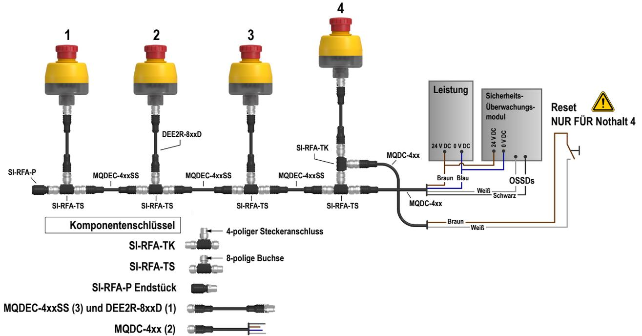
In einer langen Reihe oder in einer Reihe mit vielen ISD-Geräten muss die Spannung an allen Geräten über 19,5 V bleiben, um den einwandfreien Betrieb zu gewährleisten.
