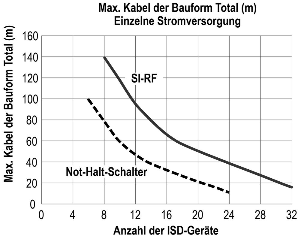
Der Strombedarf der SI-RFD Schalter und des ISD Connect ist ähnlich. Bei Verwendung mit mehreren beleuchteten ISD-Nothaltvorrichtungen richten sich die Kabellängen und den Zeitpunkt, zu dem mehr Strom benötigt wird, jedoch nach der Stromaufnahme der Nothaltvorrichtungen.
