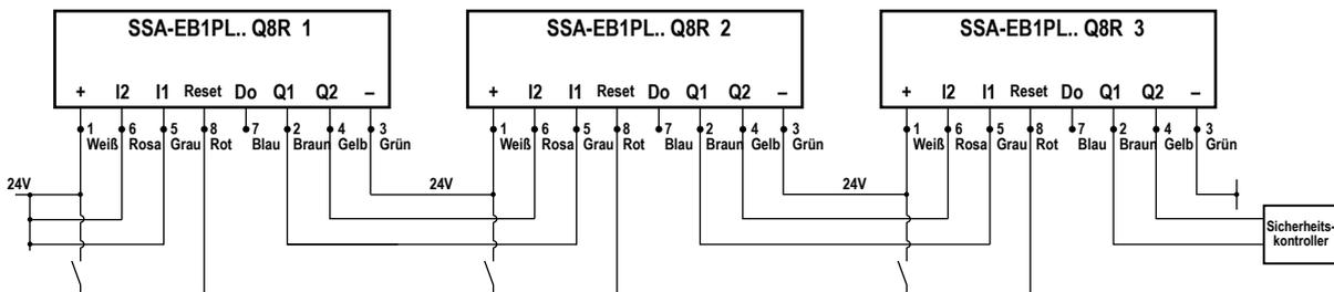
Nach dem Wiedereinschalten des Not-Halt-Geräts erfordert die optionale Reset-Funktion eine manuelle Quittierung, bevor der Sicherheitsausgang des Geräts eingeschaltet wird (nur dieses einzelne Not-Halt-Gerät, nicht die gesamte Reihe).
