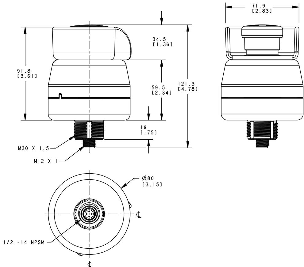
Abbildung 17. Not-Halt-Schalter mit mechanischem Kontaktschutz SSA-EB1P PLS1
