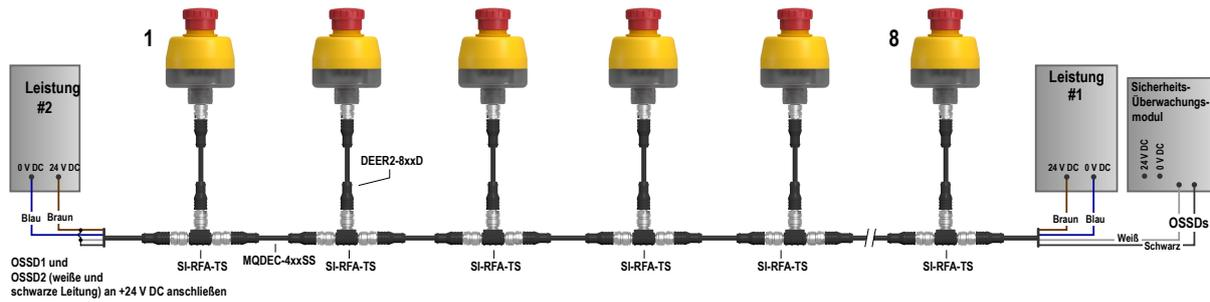
Abbildung 11. Maximale Gesamtkabellänge für eine einzelne Stromversorgung
