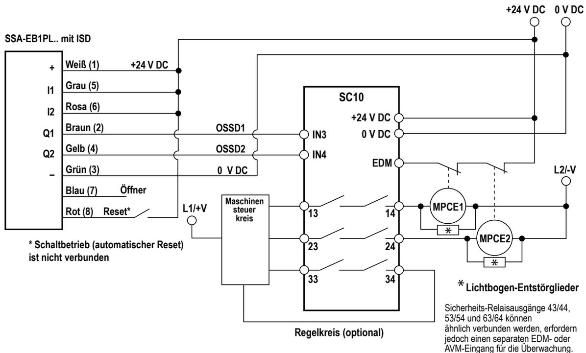
Die Beleuchteter Not-Halt-Taster mit ISD, Bauform SSA-EB1PLx-0Dx können in Reihe oder einzeln an einen kompatiblen XS26-2 oder SC10-2ro Sicherheitskontroller von Banner angeschlossen werden. Weitere Informationen zu ISD-kompatiblen Kombinationen von Eingangsanschlüssen sind der Bedienungsanleitung des XS26-2/SC10 Sicherheitskontrollers zu entnehmen.
