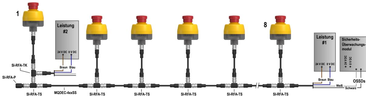
Abbildung 10. Möglichkeit 2: Ersetzen Sie den Abschlusswiderstand durch eine Stromversorgung. Die OSSD1- und OSSD2-Leiter an der Stromversorgung Nr. 2 müssen an +24 V DC angeschlossen werden. Falls verfügbar, stellen Sie die Stromversorgungen für parallel geschaltete Ausgänge ein.
