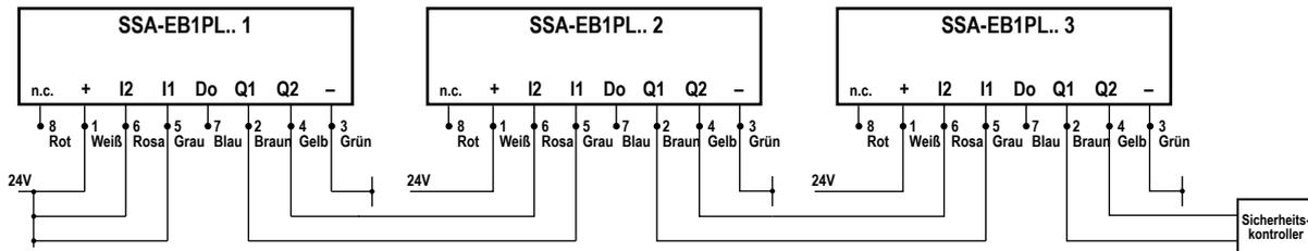
Abbildung 7. Schaltplan für Reihenschaltung mehrerer SSA-EB1PLx-0Dx..Q8R mit Reset-Funktion.
