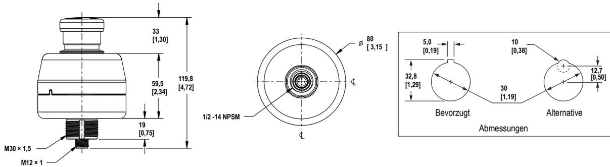
Abbildung 13. Silikon-Spritzschutz SSA-EB1P-ECWC
