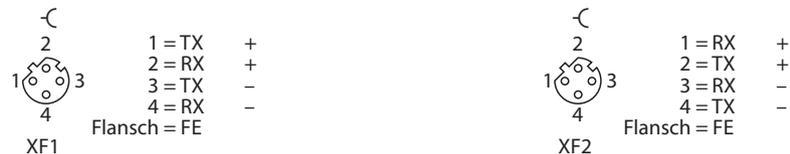
Abb. 16: Pinbelegung Ethernet-Anschlüsse
