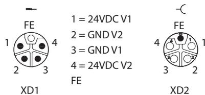
Abb. 20: Pinbelegung Versorgungsspannungsanschlüsse
