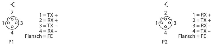
Abb. 14: Pinbelegung Ethernet-Anschlüsse
