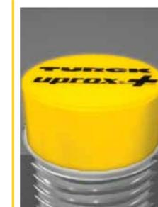
Durch einen integrierten Vorbedämpfungsschutz wird bei nichtbündigen **uprox<sup>+</sup>** Sensoren eine einzigartige Flexibilität erzielt. Im Gegensatz zu herkömmlichen Sensoren mit Ferritkern können die Freizonen hier deutlich kleiner ausfallen. Der Einbau von nichtbündigen Sensoren bis zur Rohrkante ist mit einer Schaltabstandsreduzierung möglich.
