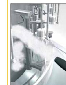
Durch eine spezielle Doppellippen-Abdichtung der einzelnen Gehäuseteile im Frontkappenbereich und am Steckereinsatz kann das Eindringen von Flüssigkeiten selbst bei einer Hochdruckreinigung verhindert werden. Damit übertreffen die **uprox<sup>+</sup>** Sensoren die Anforderungen der Schutzarten IP68 und IP69K bei weitem.
