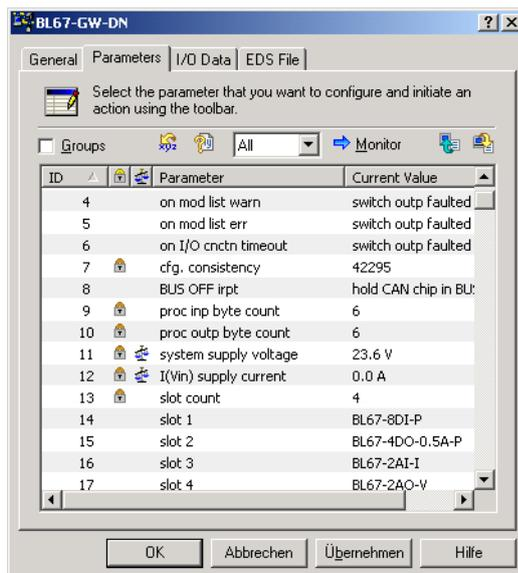
Fig. 33: Station parameters
