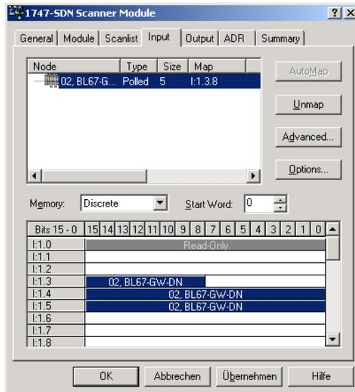
Fig. 32: Mapping the input data
