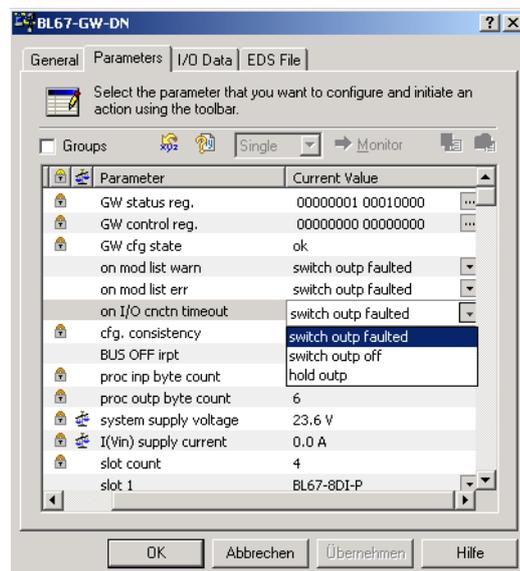
Fig. 27: Setting the gateway parameters
