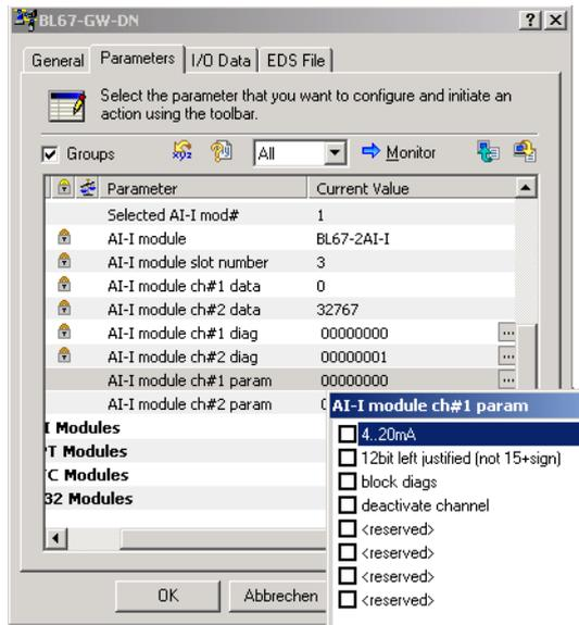
Fig. 36: Setting the parameters of a BL67 module
