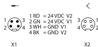
Abb. 20: TBEN-L4... – Pinbelegung Versorgungsspannungsanschlüsse
