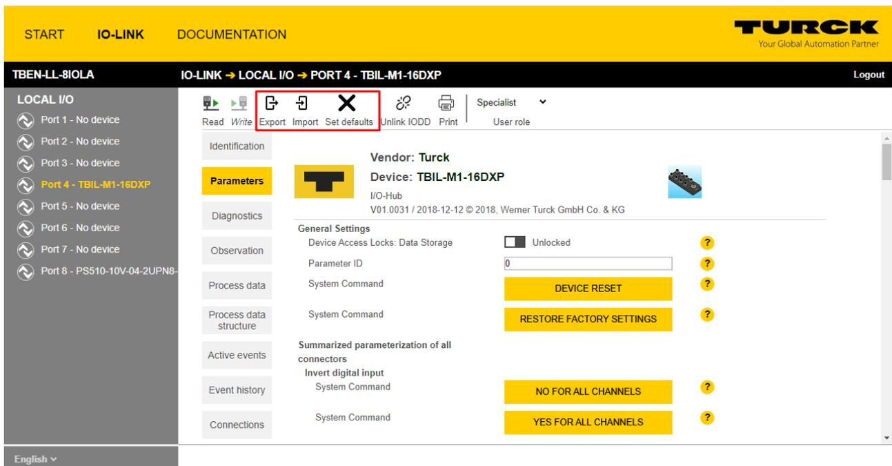
Abb. 88: Parameter eines IO-Link-Device
