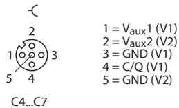
Abb. 26: Pinbelegung der IO-Link-Master-Ports, Class B, C4...C7
