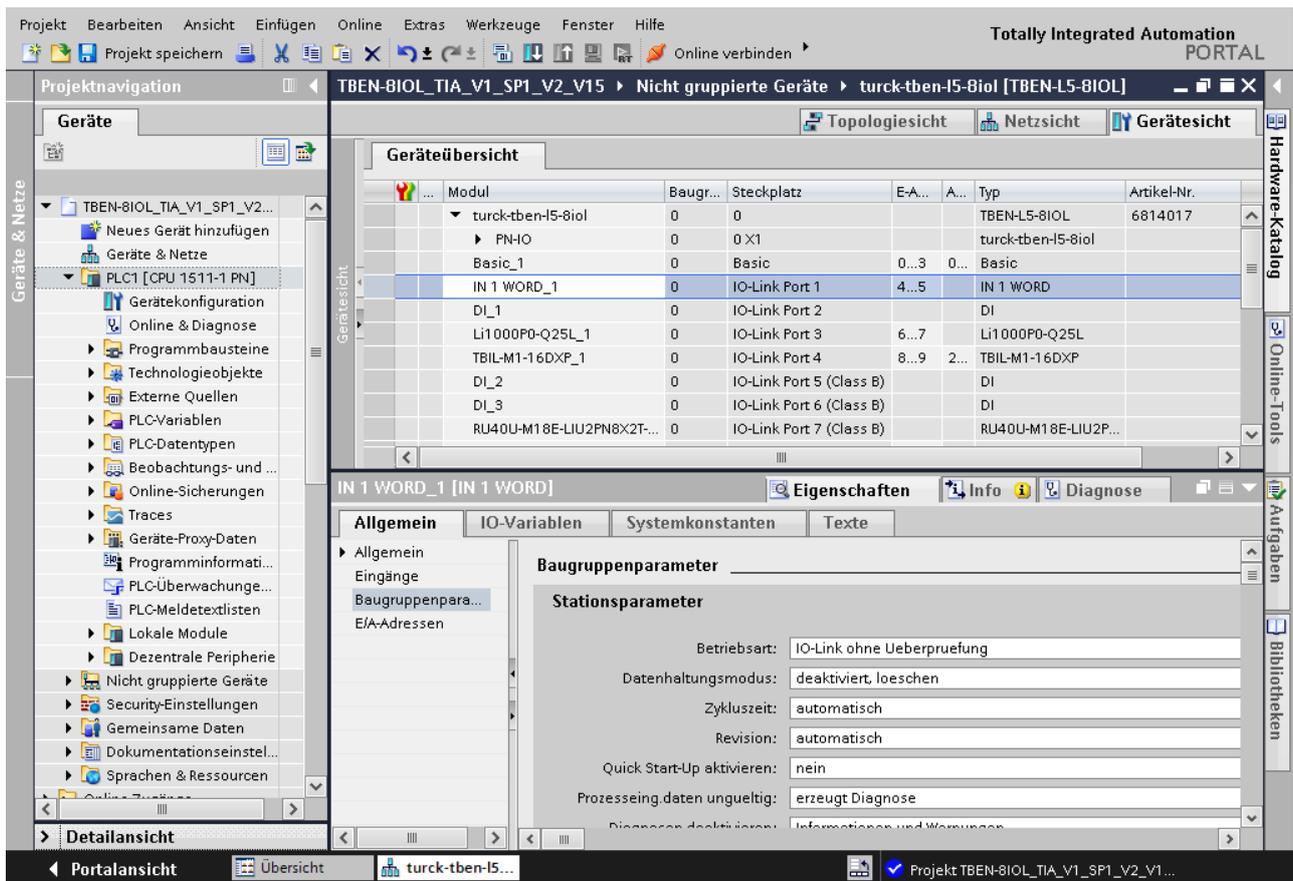
Abb. 41: TIA-Portal: Parametrieren generischer IO-Link-Devices
