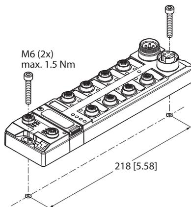
Abb. 10: Gerät auf Montageplatte befestigen
