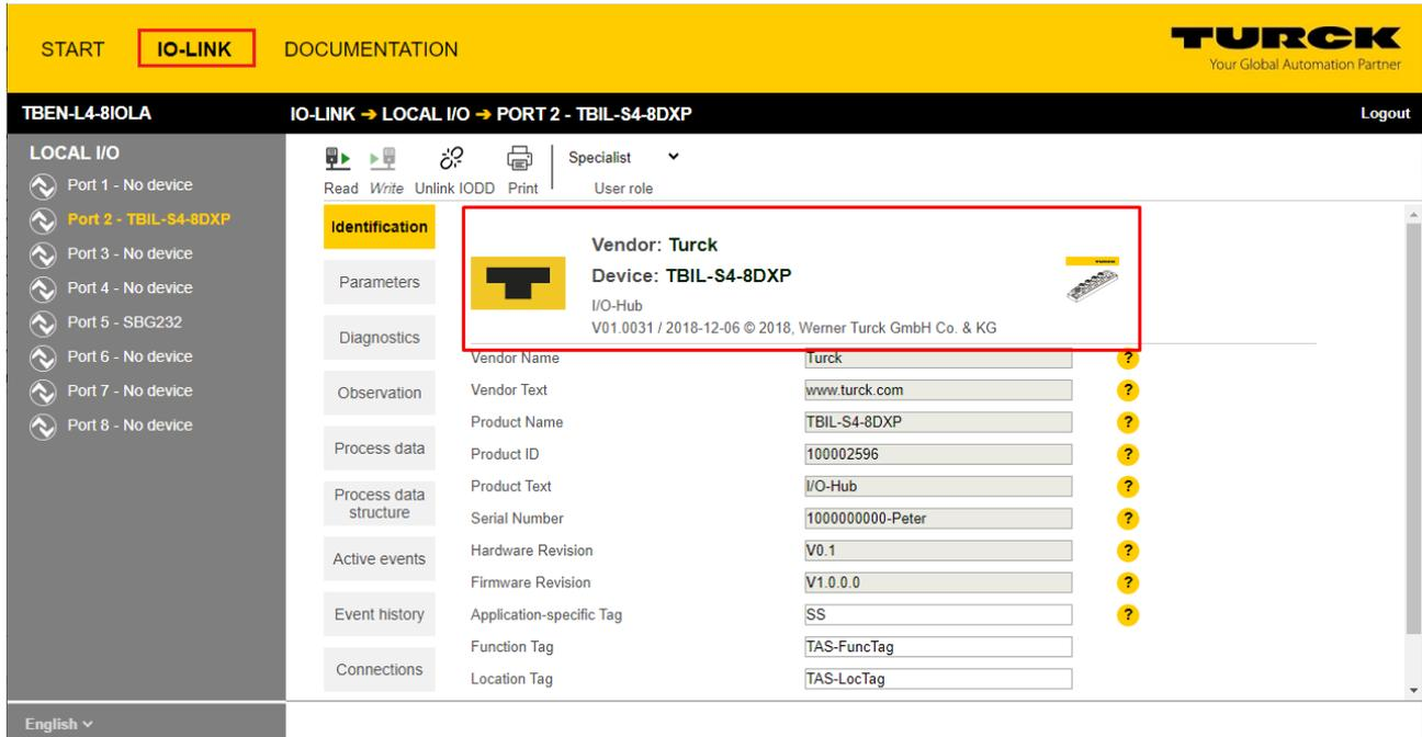
Abb. 87: IO-Link-Device mit gerätespezifischer IODD
