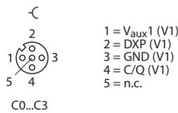
Abb. 24: Pinbelegung der IO-Link-Master-Ports, Class A, C0...C3
