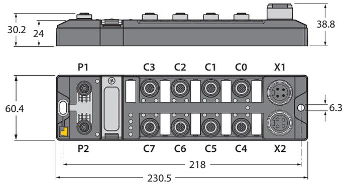
Abb. 1: Abmessungen TBEN-L4-8IOL
