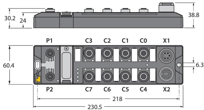
Abb. 2: Abmessungen TBEN-L5-8IOL
