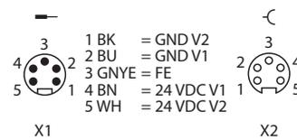
Abb. 21: TBEN-L5... – Pinbelegung Versorgungsspannungsanschlüsse
