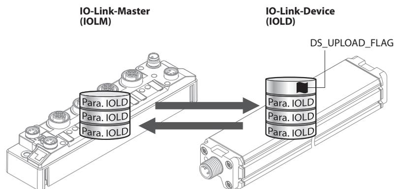
Abb. 102: Datenhaltungsmodus – generelles Prinzip, Para. IOLD = Parameter des IO-Link-Device
