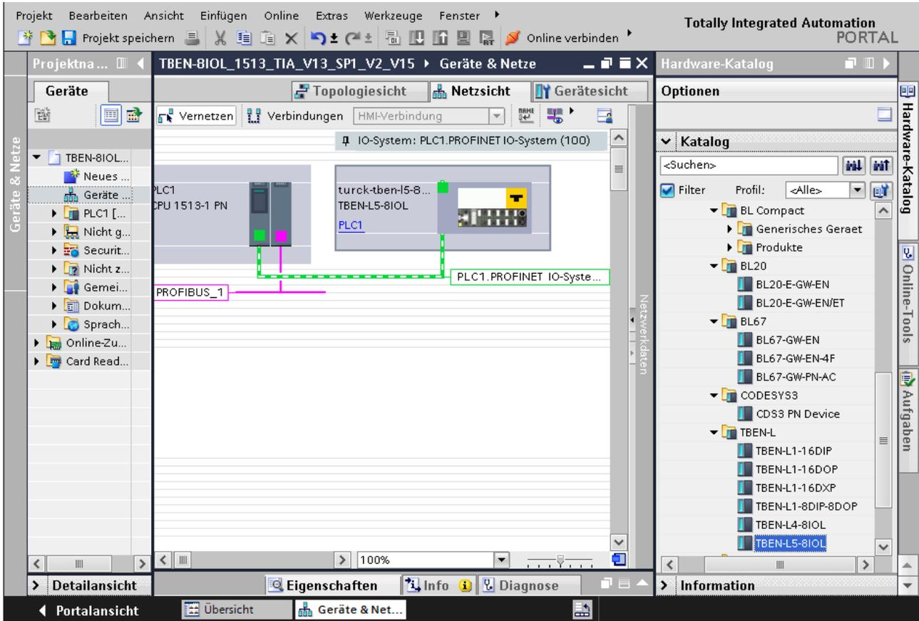
Abb. 37: Gerät mit der Steuerung verbinden
