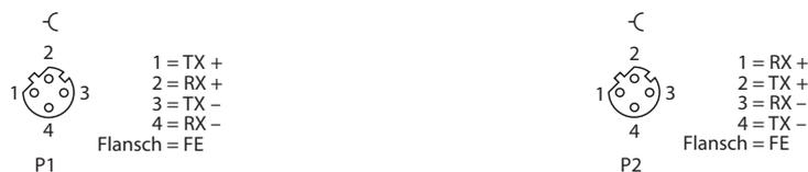
Abb. 17: Pinbelegung Ethernet-Anschlüsse
