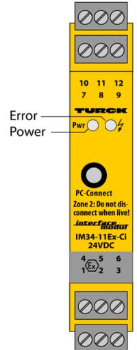
温度测量放大器IM34-11Ex-Ci/24VDC被设计用作计算随温度变化的热电阻 (RTD) Ni100/Pt100, 分度号为 B, E, J, K, L, N, R, S 和T的热电偶或范围在-160到+160 mV之间的低电压信号, 并将这些信号转换成温度线性电流信号。
