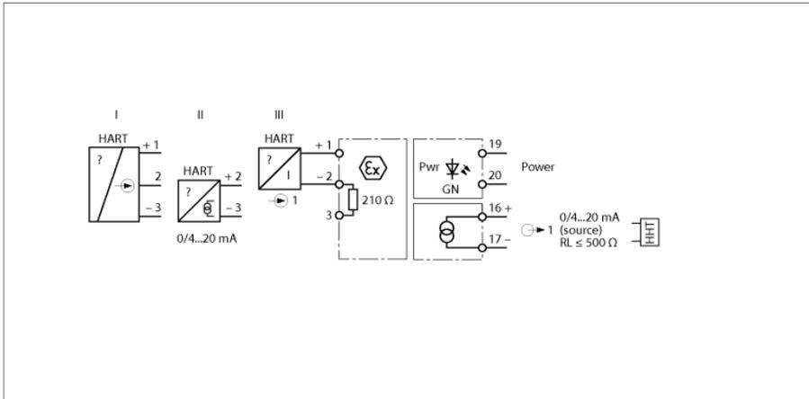
Über den 1-kanaligen HART®-Messumformer-Speisetrenner IM33-11EX-HI werden eigensichere HART®-Zwei-draht-Messumformer (III) im Ex-Bereich betrieben und das Messsignal in den Nicht-Ex-Bereich übertragen. Neben den Analogsignalen können bidirektional auch die digitalen Signale der HART®-Kommunikation übertragen werden.
