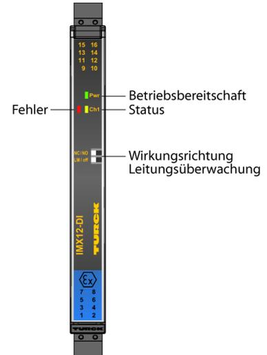
An den NAMUR-Repeater IMX12-DI03-1S-1NAM1R-PR/24VDC/CC können Sensoren nach EN 60947-5-6 (NAMUR) oder potenzialfreie Kontakte angeschlossen werden. Das Gerät ist mit einem eigensicheren Eingangskreis ausgestattet und kann in Zone 2 montiert werden. Der Ausgangskreis ist zusätzlich mit 1 Relaisausgang ausgestattet. Das Gerät kann über eine Power-Bridge versorgt werden, die auch eine Sammelstörung überträgt. Das Gerät erfüllt die Anforderungen der NE21.
