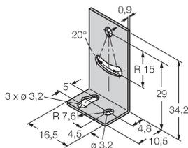
ángulo de montaje; material VA 1.4401, para optosensor modelo Q12
