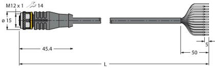
RKS12T-2/TXL 6626917 Cable de conexión, conector hembra M12, recto, de 12 polos, blindaje en la tuerca de acoplamiento; longitud de cable: 2 m; material de revestimiento: PUR, negro; aprobación cULus
