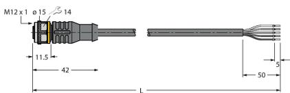
Cable de conexión, conector hembra M12, recto, 5 polos, longitud de cable: 2m, material de la funda: PVC, negro; homologación cULus; disponibles otras longitudes de cable y variantes, véase [www.turck.com](http://www.turck.com)
