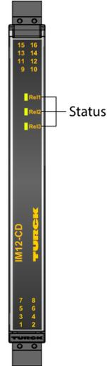
El acoplador por relé de un canal IM12-CD01-2R-1U-0/L/CC está diseñado para un aislamiento galvánico seguro entre los circuitos de contacto y de control. El dispositivo también permite la creación de aplicaciones relacionadas con la seguridad que se extienden hasta la categoría SIL3 (alta y baja demanda en conformidad con CEI 61508).
