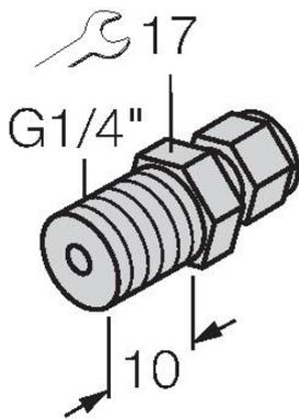
Raccordement par bague de serrage pour le montage direct de sondes de température ; diamètre sonde 3 mm ; raccordement au processus filetage extérieur G1/4"
