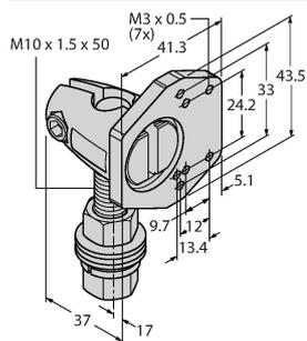
bride de fixation, orientable, acier inoxydable, pour les détecteurs des séries Q4X/Q3X, filetage M10 x 1,5
