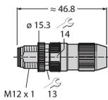
Connecteur mâle confectionnable, M12 x 1, droit, 4 pôles, raccordement par borne guillotine, diamètre de ligne 4.0 à 5.1 mm, section conducteur/section raccordable 0,14 à 0.34 mm<sup>2</sup>, boîtier plastique, écrou de montage métallique
