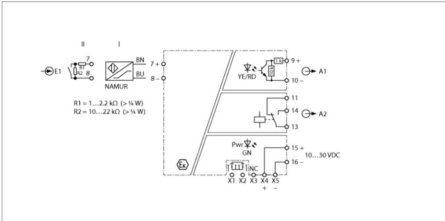
Des détecteurs suivant EN 60947-5-6 (NAMUR) ou des contacts libres de potentiel peuvent être raccordés au répéteur NAMUR IMX12-DI03-1S-1NAM1R-PR/24VDC/CC L'appareil est équipé d'un circuit d'entrée à sécurité intrinsèque et peut être monté en zone 2. Le circuit de sortie est de plus équipé de 1 sortie par relais. L'appareil peut être alimenté par un power-bridge, qui transmet aussi une alarme collective. L'appareil répond aux exigences de la NE21.
