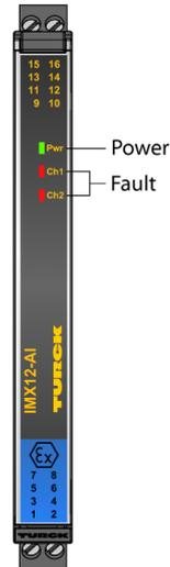
Le convertisseur de mesure-séparateur d'alimentation à 2 canaux IMX12-AI01-2I-2IU-H0/24VDC alimente des convertisseurs de mesure à sécurité intrinsèque 2 fils HART® dans la zone Ex et transmet les signaux mesurés à la zone non Ex.
