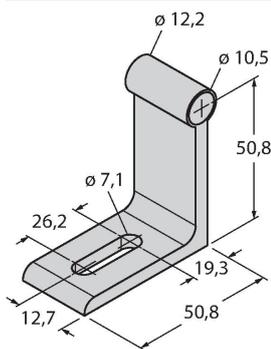
Монтажный кронштейн для стержня, для наружного монтажа
