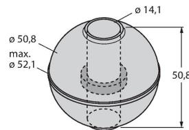
Позиционирующий элемент поплавкового типа, удельный вес 0,62 кг/м³, подходит для наружного монтажа для мониторинга уровня, материал: Нержавеющая сталь
