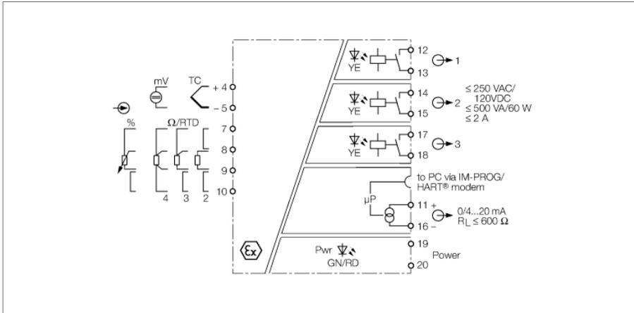
Одноканальный температурный измерительный преобразователь IM34-14Ex-CDRI служит для работы с термосопротивлениями (RTD) Ni100/Pt100, термопарами типа B, E, J, K, L, N, R, S и линейаризации выходного токового сигнала температуры 0/4...20 мА. Также возможно подключение резисторов, потенциометров или источников низкого напряжения для линейаризации сигналов в диапазоне -160...+160 мВ.
