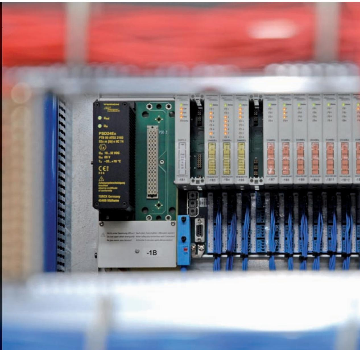
**Turcks Remote-I/O-System excom stellt bis zu 128 binäre oder 64 analoge Kanäle auf kleinstem Raum zur Verfügung**
