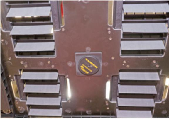
Der Blick von unten auf den Werkstückträger zeigt den zentral montieren Datenträger und vier Heckentlüftungen mit den Lamellen
