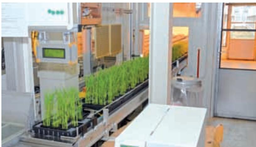
**Wenn die Pflanzen das aktuelle Programm durchlaufen haben, werden sie ausgeschleust; die ausgelesenen Daten sind oben im Display zu erkennen**
