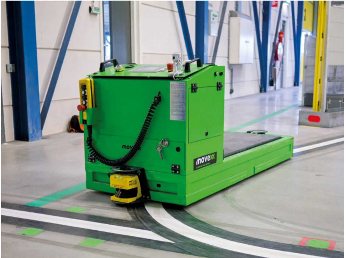
An Kreuzungen und anderen Schlüsselpunkten sind RFID-Tags im Boden eingelassen, die dem AGV Positionsinformationen geben
