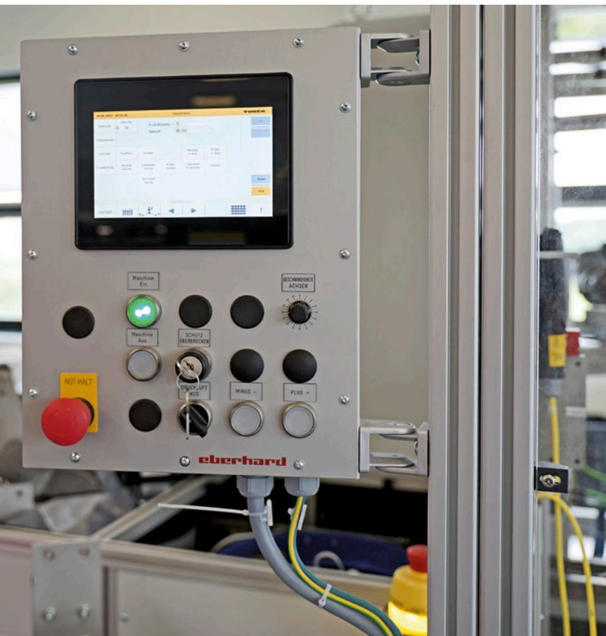
Zur Visualisierung und Cloud-Anbindung dient ein Turck-HMI aus der Serie TX700
