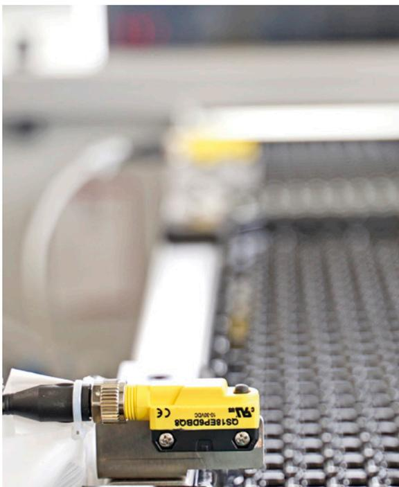
Ein QS18-Opto-Sensor erfasst das Tray, auf dem die fertigen Buchsen später abgelegt werden
