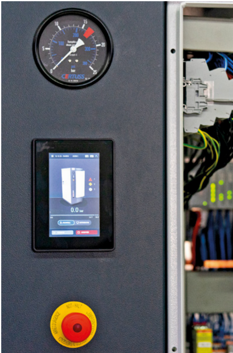
Das GUI auf dem HMI TX705 wurde in enger Zusammenarbeit mit Turck grundlegend überarbeitet, um die „User Experience“ exakt nach Certuss-Vorgaben abzubilden
