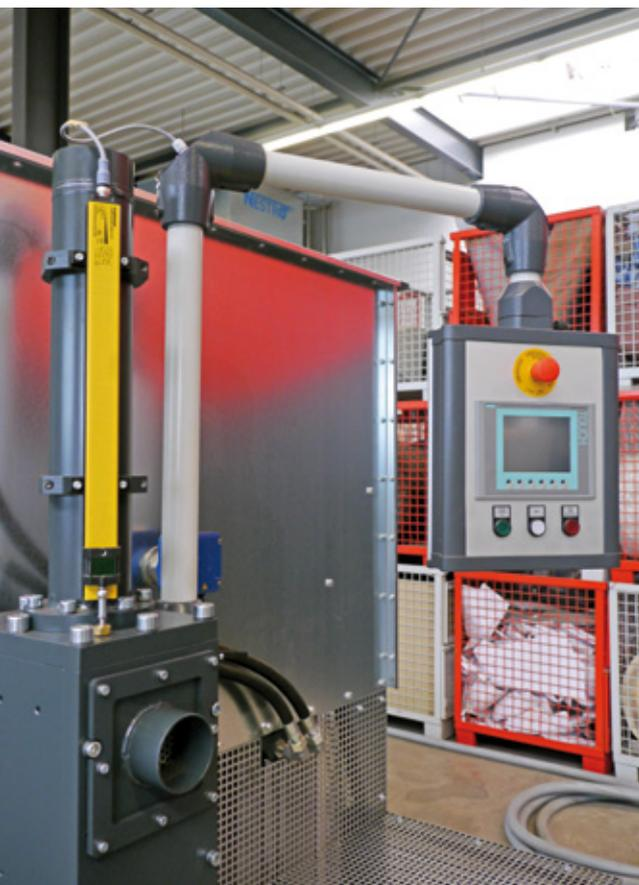
**Das analoge Signal des LI-Sensors am Vorverdichter wird direkt am Bedienpanel visualisiert**
