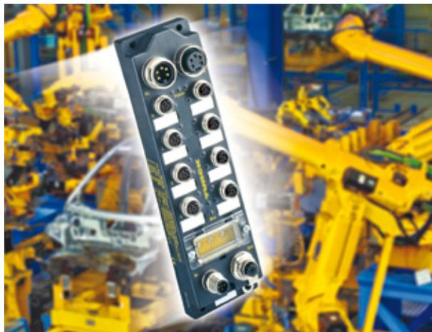
Die Schnellstart-I/O-Module lassen sich dank ihres integrierten Switches auch in Linientopologie installieren. Turck bietet die Module mit vier unterschiedlichen Anschlusskonfigurationen an: 16 frei konfigurierbare Ein- oder Ausgänge, 16 Eingänge oder 16 Ausgänge sowie eine Version mit je 8 Ein- und 8 Ausgängen. Alle Varianten sind nicht nur für Ethernet/IP, sondern auch für Modbus erhältlich.
