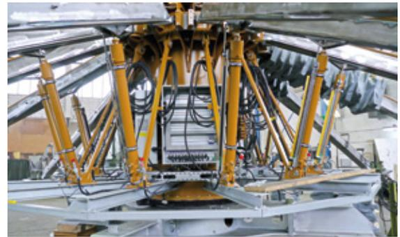
Im Rundfahrgeschäft Flying Fish erfasst Zierer die horizontale Lage der Gondelarme jetzt mit induktiven Linearwegsensoren von Turck. **Seite 22**
