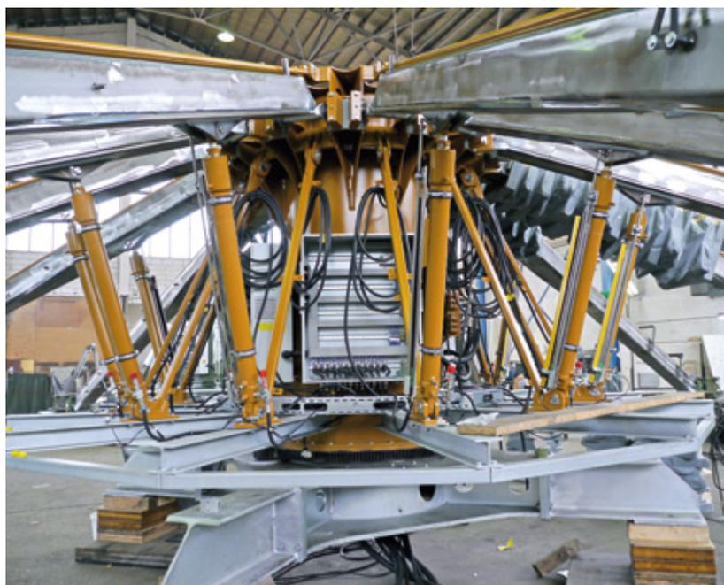
**Statt wie bisher pro Hydraulikzylinder fünf Näherungsschalter einsetzen zu müssen, liefert heute ein 1.000-mm-Linearwegsensor von Turck die exakte Armposition**
