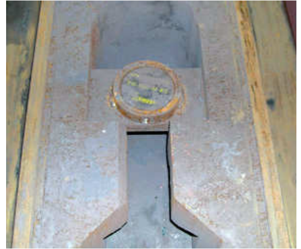
Der Datenträger ist in einen Stahling eingelassen und wird trotzdem zuverlässig gelesen
