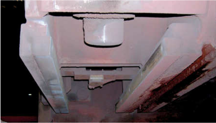
In die Schienen des Walzgerüsts werden die Käfige eingeschoben. Der Schreiblesekopf (Bildmitte) identifiziert den Datenträger am Walzgerüst
