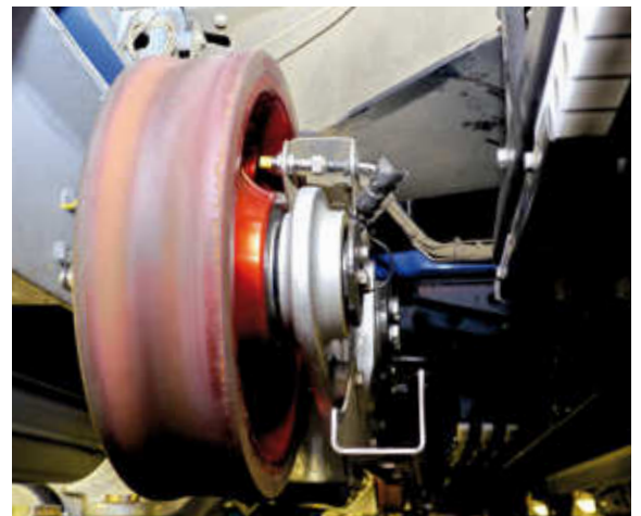
Das Loch im Alu-Rad des Megacoasters erfasst der uprox+ mit seinem präzisen Schaltpunkt zuverlässig
