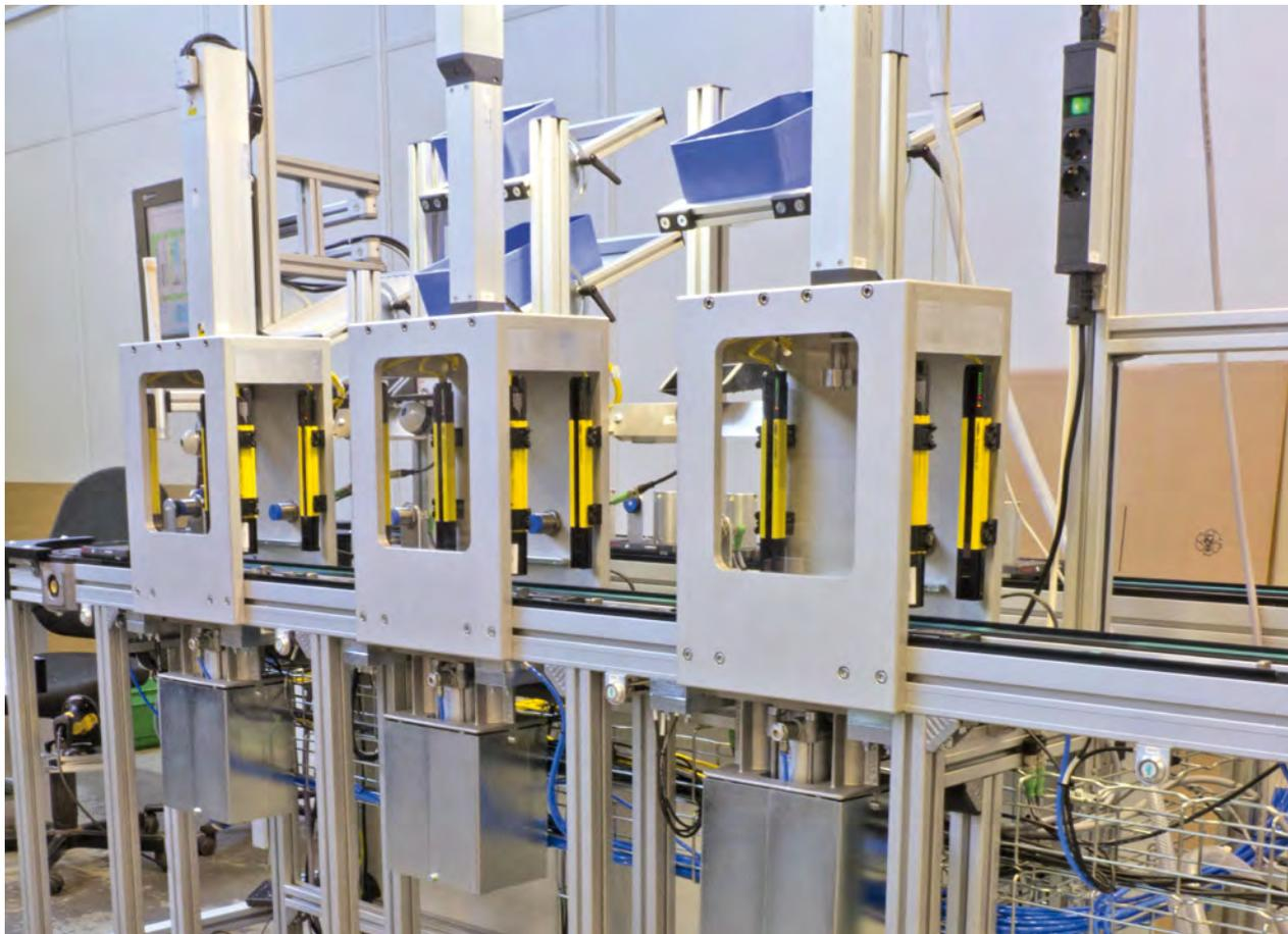
den. Voraussetzung für diese Kaskadierung ist, dass alle Lichtgitter dieselbe Bedingung überprüfen. Die mögliche Alternativlösung einer mechanischen Türsicherung des Einpressvorgangs verwarf Oleg Oster und Uwe Binder schnell. Zu aufwändig wären Einrichtung, Montage und Wartung gewesen. Auch preislich war diese Alternative nicht attraktiv.
