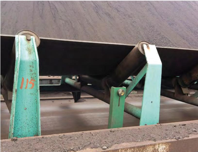
Am Förderband des Schaufelradbaggers sind RFID-Datenträger zur Positionsermittlung montiert
