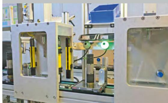
Für die sichere Montage von Rolladenmotoren vertraut Elero auf EZ-Screen-Lichtgitter und eine Pick-to-Light-Lösung aus dem Turck-Programm. **Seite 28**
